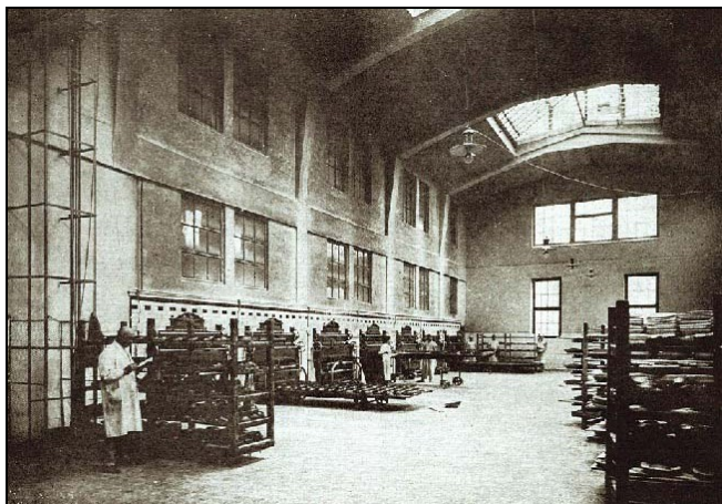
Pekárenská dvorana s parními vyťahovacími pecemi a parní pece pro ruční sázení pečiva, obojí v nové budově pekárny v Holešovicích, 1911
