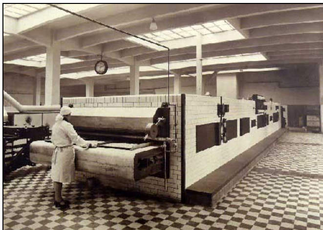
Elektrická řetězová pec dlouhá 18 metrů určená pro výrobu oplatek
